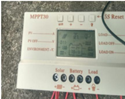
Gambar 5. MPPT 30 Ampere dengan output PWM
